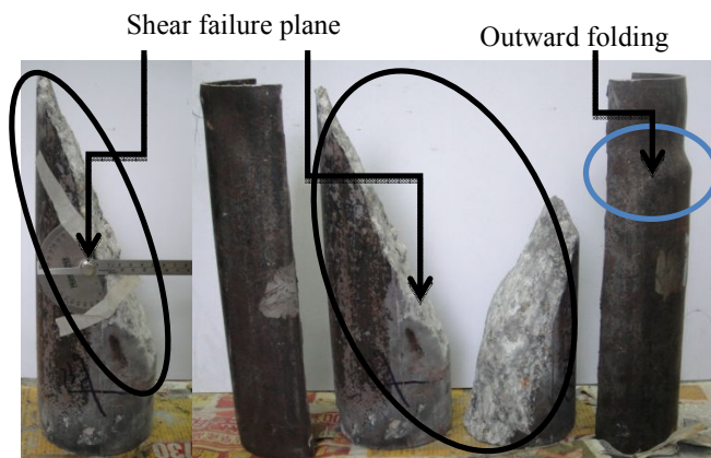
(d) Failure modes of concrete core of UHSCFST columns (CN0-4-139-120)
