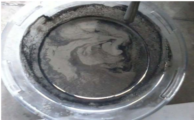
Fig. 1 Cement- MWCNTs & DI water paste
