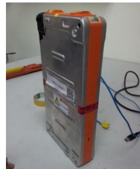
Fig. 2 Li-Ion Battery Module
