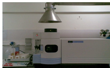
Fig. 3 Perkin-Elmer Optima 2100 DV, ICP-OES
