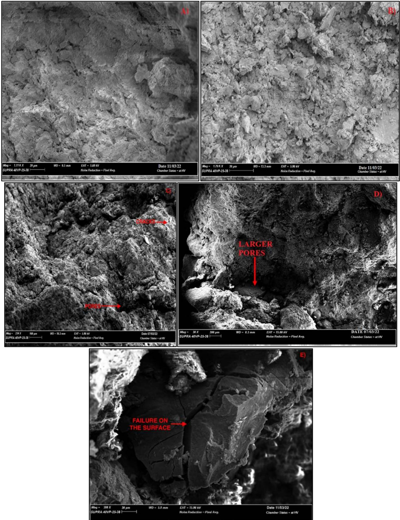
Fig. 3 SEM Microstructure of different rubber crumbs percentages: (a) 0.5 wt.%RC, (b) 1 wt.%RC, (c) 1.5 wt.%RC, (d) 2 wt.%RC, (e) 2.5 wt.%RC
