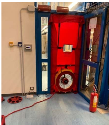
Fig. 6 Door Fan Test in Portopalo CED
