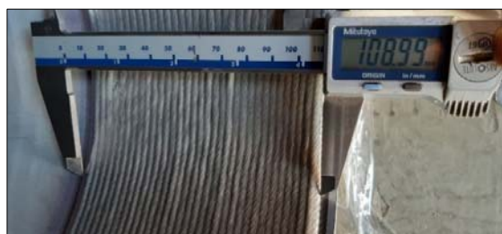
Fig. 7 Pipe straight edge cladding
