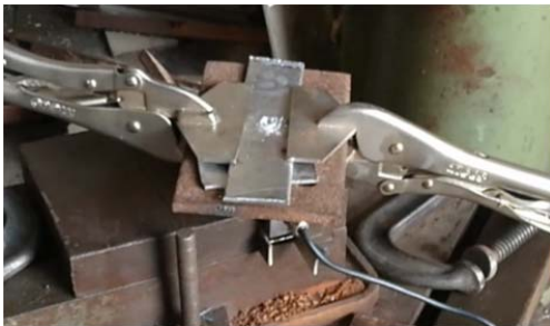
Fig. 4 FSSW specimen fixation
