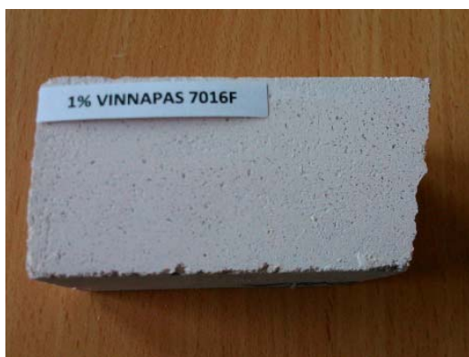
Fig. 6 Geopolymer mortar specimens containing 1% VINNAPAS® 7016 F
