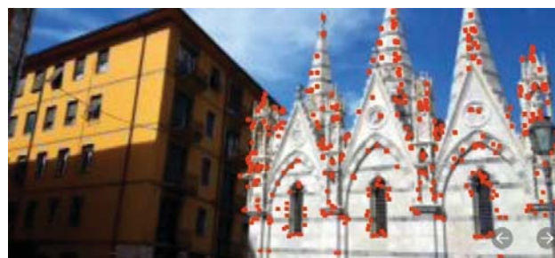
Fig. 4 SLAM feature map for Chiesa di Santa Maria della Spina
