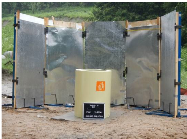
Fig. 7 Blast test layout
